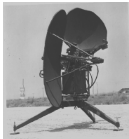
Figure R54 AN/TPN-18 X-band PAR antenna system (ITT Gilfillan Co. photo).
